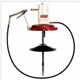
Grease Pump Assm. 120#/Pompe à lubrifier ultra robuste pour tambour série 120 - Ratio de 50:1 - Comprend conduit conique pour seau, tuyau de 7 pi, pivot universel et valve #740. Code : LIN / 331 / 917
